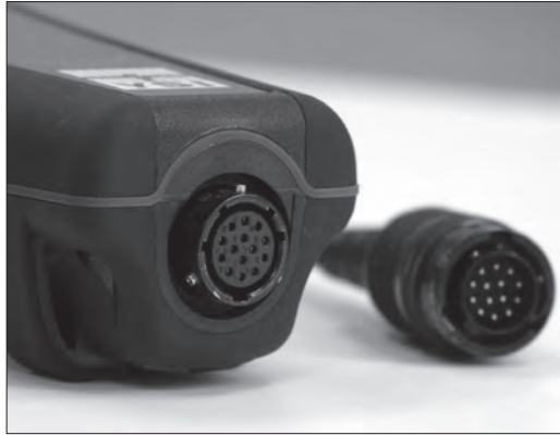
Figura 5. Véase el conector con guías posicionadoras. El cable y los conectores del instrumento sólo pueden coincidir si las guías posicionadoras están correctamente alineadas.
